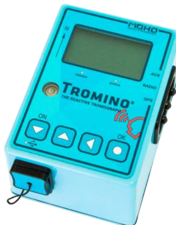
Figura 1.11 – Tromino utilizzato per effettuare le indagini di sismica passiva di tipo HVSR.
